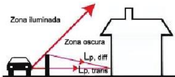
Figura 4. Forma del apantallamiento de la transmisión del sonido por una barrera sonora.
