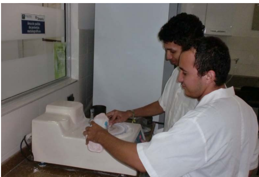
Gráfica 5. Preparación de probetas para el análisis metalográfico
