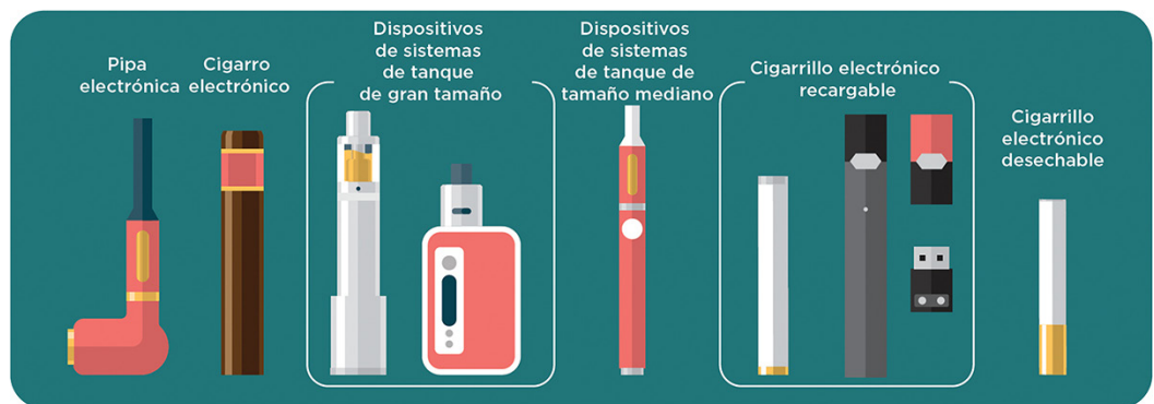
Figura 2. En la figura se observa un cigarrillo electrónico desechable, muy parecido a los cigarrillos de tabaco, de la primera generación; posteriormente surgieron los dispositivos de tanque mediano y actualmente son muy populares los de tanque de gran tamaño, que pertenecen a la tercera generación. También se observan los cigarrillos electrónicos recargables que corresponden a los nuevos dispositivos de tabaco calentado. La pipa y el cigarrillo electrónico parecido a un puro son versiones distintas de los de primera generación. Modificado de National Institute on Drug Abuse (NIDA), 2020.
