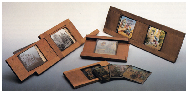
Imagen N° 20: Chasis mecánicos para permitir que una linterna mágica con un sistema simple de proyección pudiera narrar historias de forma secuencial.
