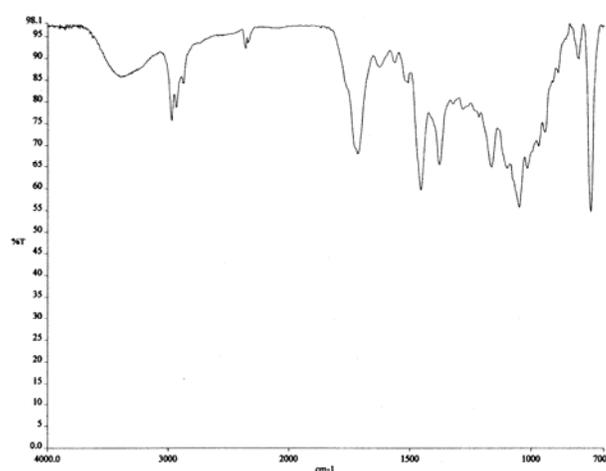
**Figura 7. Espectro IR en  $\text{CHCl}_3$  del producto ácido 2.**
