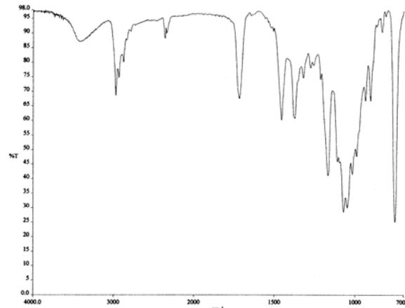
**Figura 9. Espectro IR en  $\text{CHCl}_3$  del producto básico 2.**
