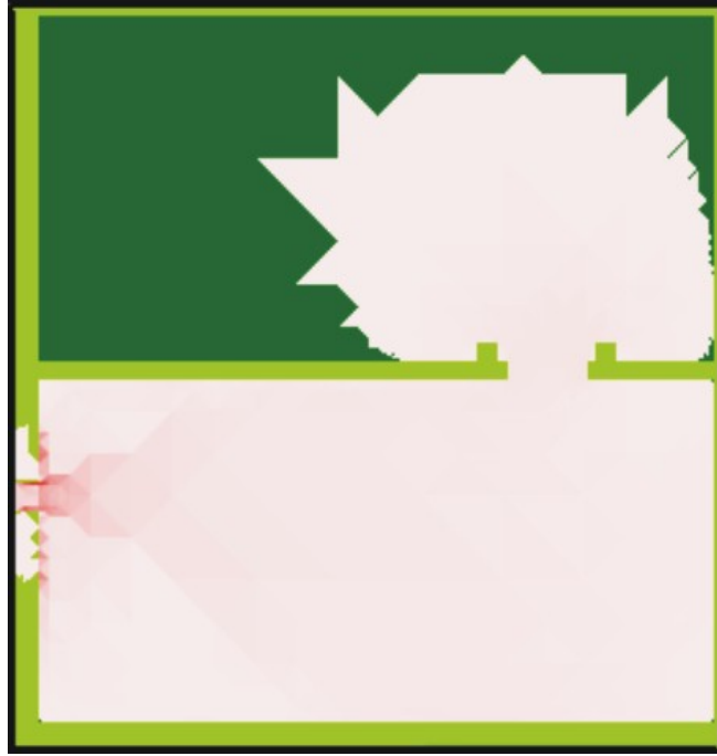
Figura 11. Avance global del agua y módulo de velocidad en todo el terreno a los 11 segundos.
