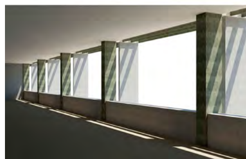
Figura 14. Simulación de las condiciones de asoleamiento sobre las aulas junto a la fachada norte el 21 de junio con el sol a las 11:00 a. m. (elaborado con Revit ©).
