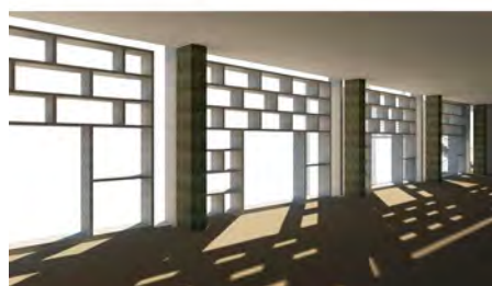
Figura 15. Simulación de las condiciones de asoleamiento sobre el corredor junto a la fachada sur el 21 de diciembre a las 4:00 p. m. (elaborado con Revit ©).
