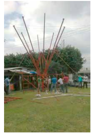
Figuras 64 a 66. Se realizó una prueba de movilidad de los brazos principales sin membrana, esto para probar la resistencia de los malacates y la velocidad en la cual se debería tener la resistencia adecuada a la hora de desplegar el sistema transformable Fuente: Morales (2013).
