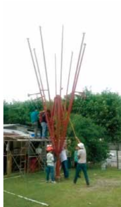
Figuras 64 a 66. Se realizó una prueba de movilidad de los brazos principales sin membrana, esto para probar la resistencia de los malacates y la velocidad en la cual se debería tener la resistencia adecuada a la hora de desplegar el sistema transformable Fuente: Morales (2013).
