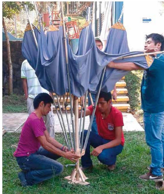
Figuras 8 y 9. El desplegado del modelo ayudó a formar conceptos constructivos del movimiento del sistema plegable del paraguas Fuente: Morales (2013b; 2016, fig. 17).
