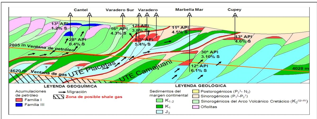
Fig. 8. Esquema geólogo-petrolero del área Cantel-Cupey [13]. Aquí se muestra cómo la tectónica de cabalgamientos provoca que los sedimentos del margen continental ( $J_3-K_2$ ) actúen como rocas madre y reservorios a la vez, y posible zona de *shale gas*.
