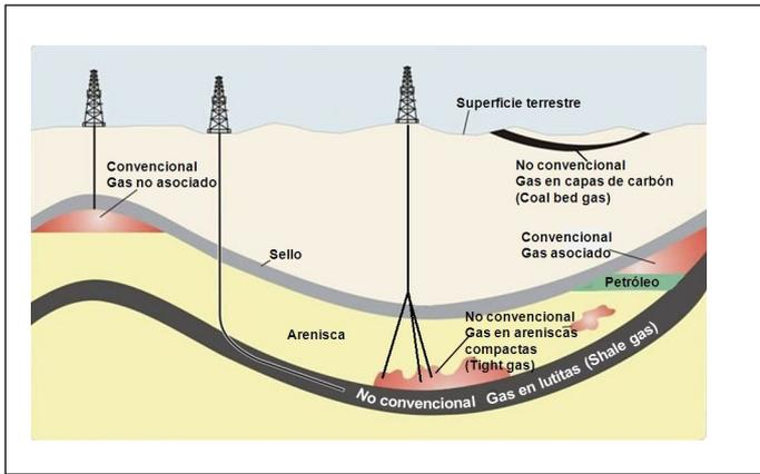
Fig. 2. Distribución esquemática de las acumulaciones de gas natural (convencional y no convencional). Tomado de <http://www.offshore-echnology.com/features/feature97304/feature97304-1.html>.
