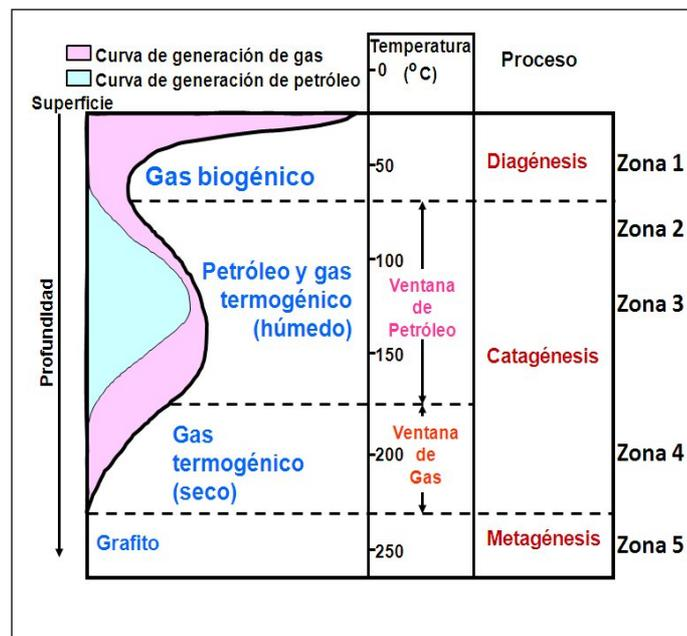
Figura 1. Etapas de generación de petróleo y gas en relación con la profundidad y la temperatura. [2]
