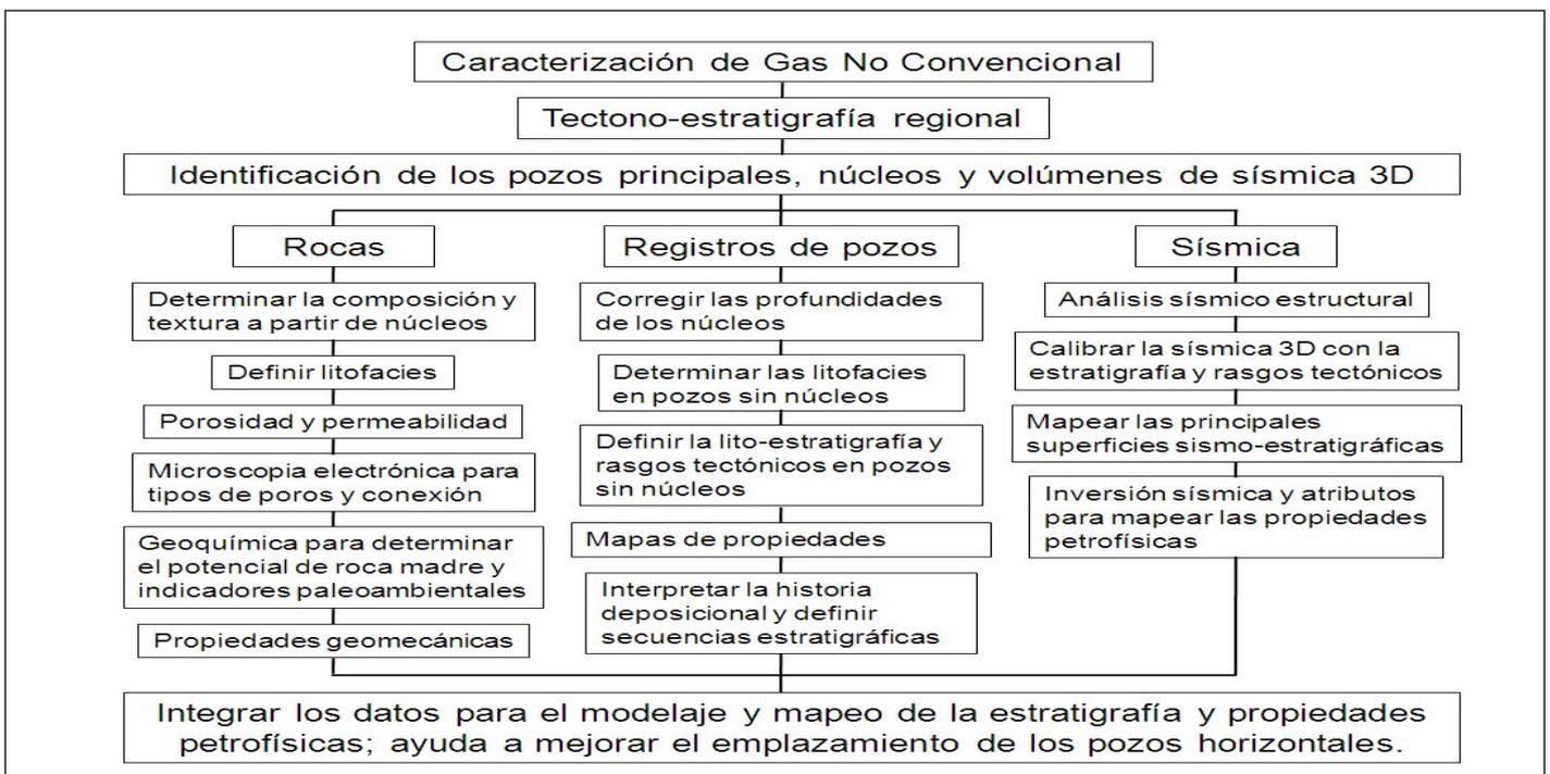
Fig. 3. Flujo de trabajo para el estudio del gas de lutita. [7]
