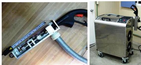
**Figuras 1 y 2.** (Izq.) Cavity portátil del láser de limpieza; (der.) vista general del equipo.
