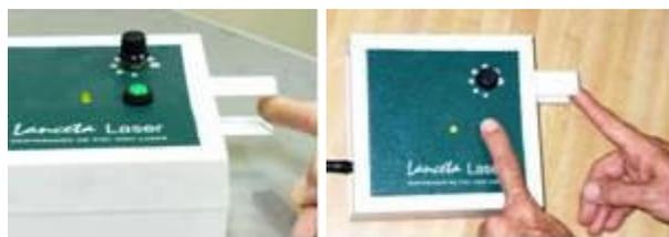
**Figura 5.** Proceso de toma de muestra de sangre. A la izquierda se muestra como se posiciona el dedo en la zona de incidencia. A la derecha el operario oprime el interruptor de disparo. El pulso láser será emitido en el momento en que la superficie del dedo interrumpa la barrera de luz en el punto focal.
