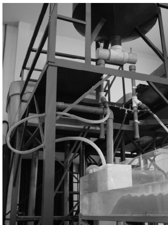
Figura 3 - Sistema de alimentação de areia.
