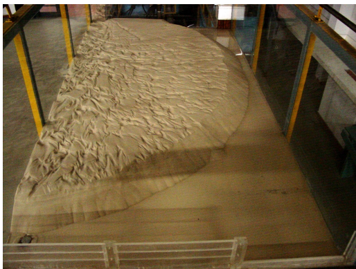
Figura 19 - Vista superior do assoreamento com 72h.
