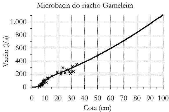
Figura 7 - Curva chave da seção de controle.
