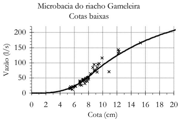
Figura 8 - Curva chave da seção em cotas baixas.
