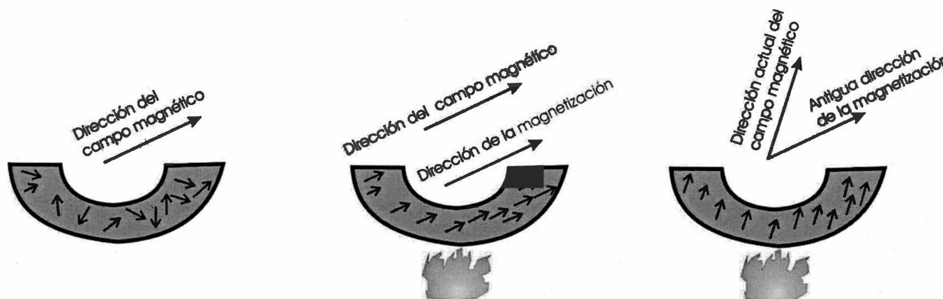
Fig. 31. Ilustración del proceso de adquisición de magnetización termorremanente en la pared de un horno.
