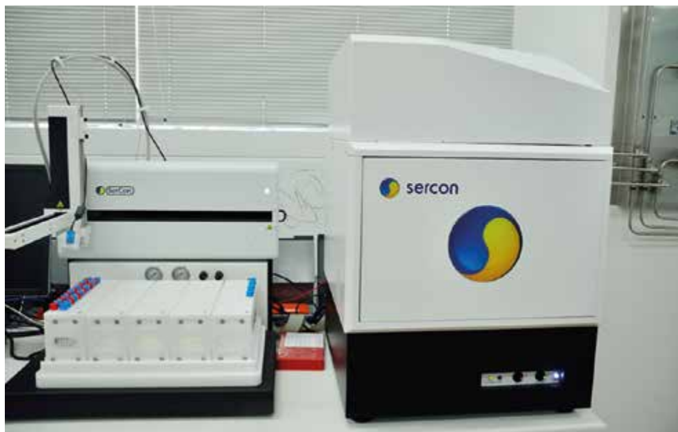
Figura 4. Modelo de espectrómetro de masas de relación isotópica tipo Sercom®, en donde se identifican, a la derecha el espectrofotómetro y a la izquierda la bandeja de muestreo automático. Cortesía del Laboratorio Clínico Hematológico S.A. Medellín, Colombia.
