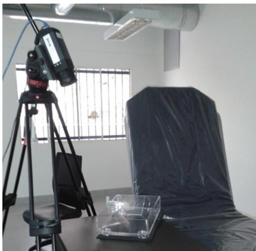
Figura 1. Sistema de medición: cámara termográfica, camilla y soporte de acrílico.
