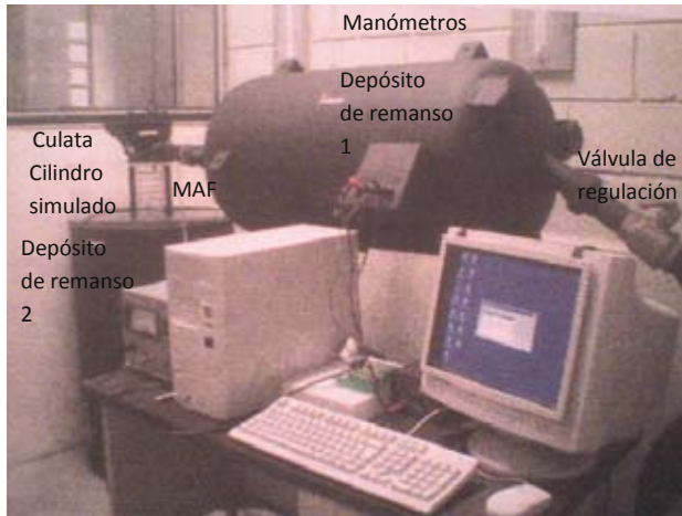
Figura 3. Instalación del banco de flujo estacionario
