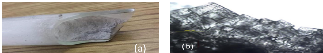
Figura 12. Cristales precipitados en el elemento de prueba (a) y vistos al microscopio (b).
