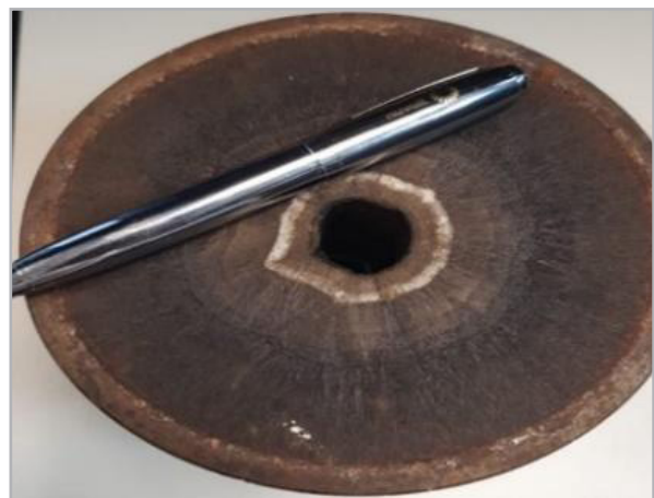
Figura 3. Reducción del diámetro de tubería de producción por presencia de incrustaciones minerales de \text{CaCO}_3 .
