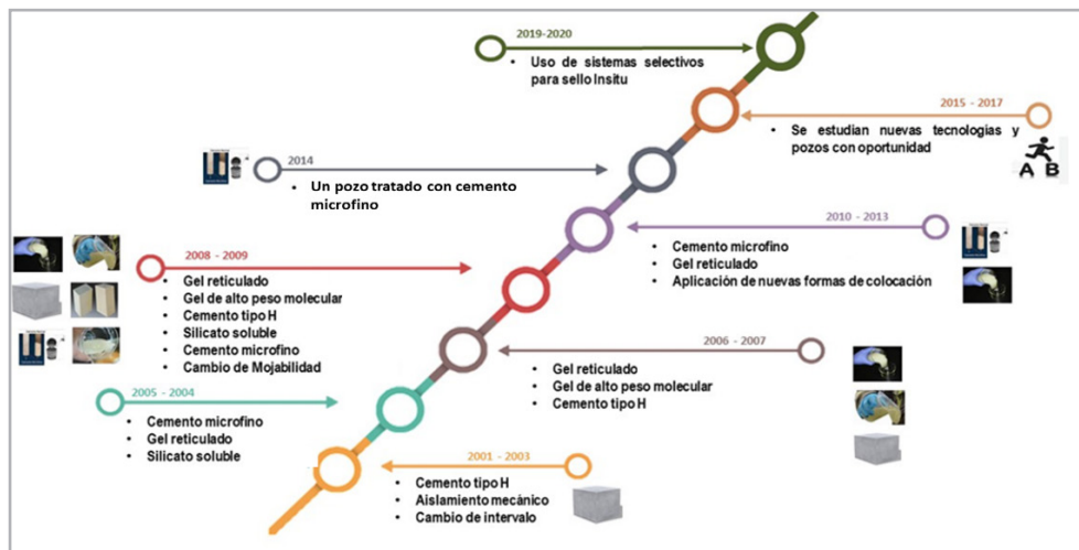
Figura 2. Tratamientos químicos para el control de agua aplicados en pozos costa fuera.
