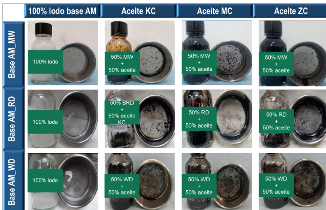
Figura 8A. Incompatibilidad de 3 lodos base agua de mar (AM), con aceites Cretácicos.
