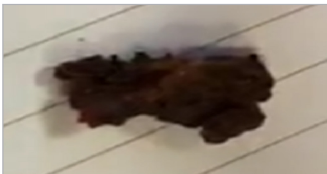
Figura 5. Polímero tipo silicón recuperado en las ranuras de un liner de producción.
