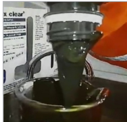
Figura 1. Emulsión entre lodo base agua de mar y aceite Cretácico, recuperado en la limpieza del pozo marino K-52.
