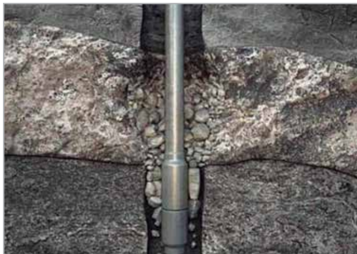
Figura 6. Acuñaamiento mecánico de la sarta de perforación por la influencia de la falla geológica 4 .
