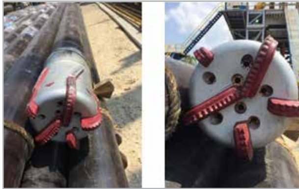
Figura 8. Zapata perforadora instalada en la tubería de revestimiento de 13 3/8" 3 .
