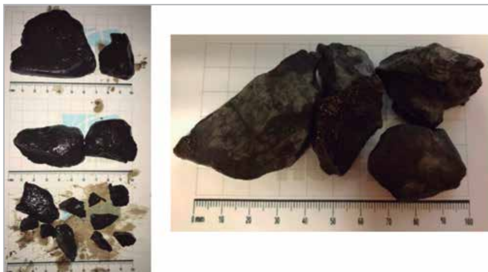
Figura 7. Recortes provenientes de la falla geológica que causaba acuñaamiento a la tubería de revestimiento 3 .
