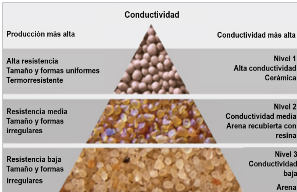
Figura 3. Disponibilidad y clasificación de apuntalantes en función de su resistencia al esfuerzo de sobrecarga e inducción esperada de conductividad.
