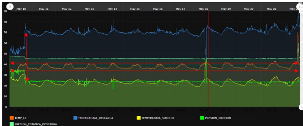
Figura 15. Comportamiento de presión y temperatura de descarga del MTC. Pozo R-168.
