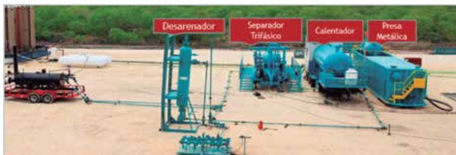
Figura 10. Fotografía de un equipo de aforo tipo.
