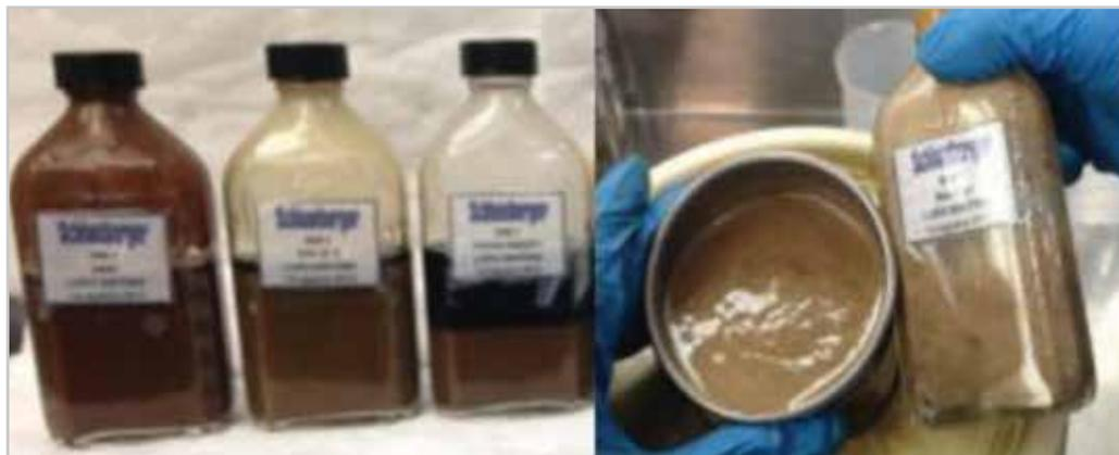
**Figura 6.** Prueba de compatibilidad lodo-recortes y sistemas ácidos y no ácidos.
