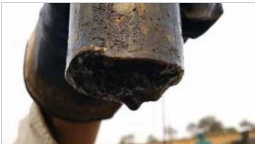
**Figura 6.** Parafinas en block impresor.
