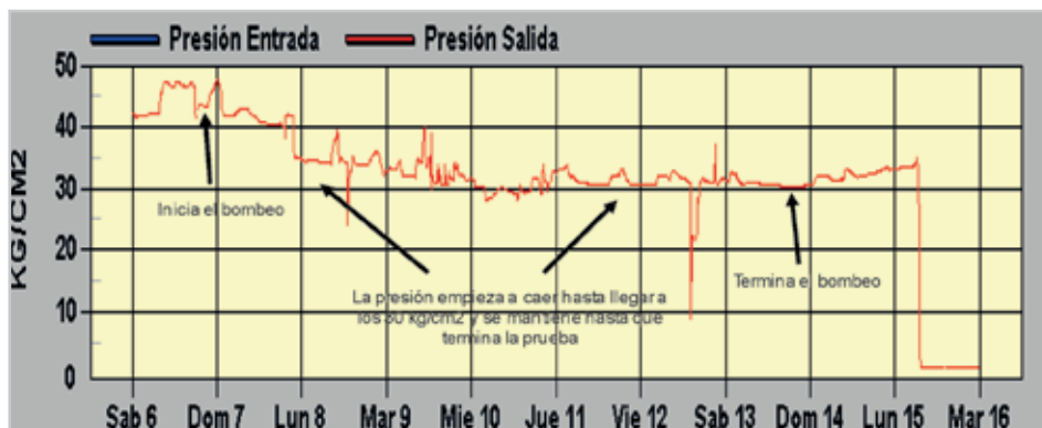
Figura 8. Medición de presión para ducto de 48 km de longitud.
