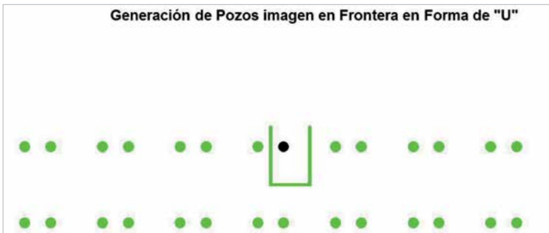
Figura 4. Generación de pozos imagen para tres fallas en forma de "U".
