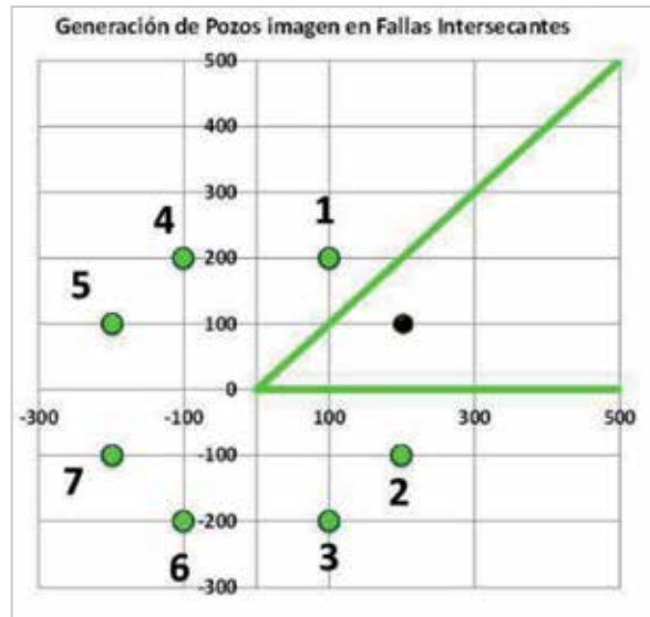
Figura 3. Generación de pozos imagen para dos fallas intersectantes.
