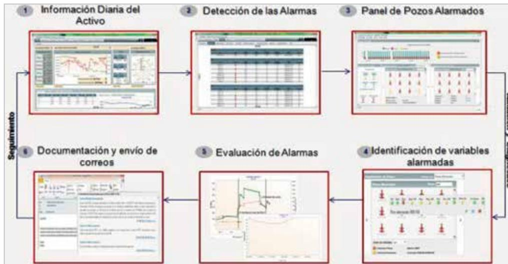
Figura 22. Esquema con la implementación de la sala de seguimiento.
