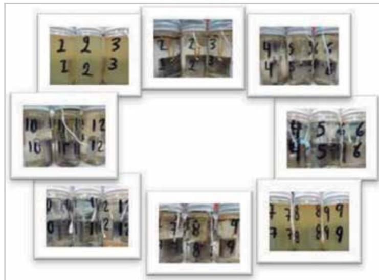
Figura 7. Preparación de cupones antes de meterlos en el corrosímetro.
