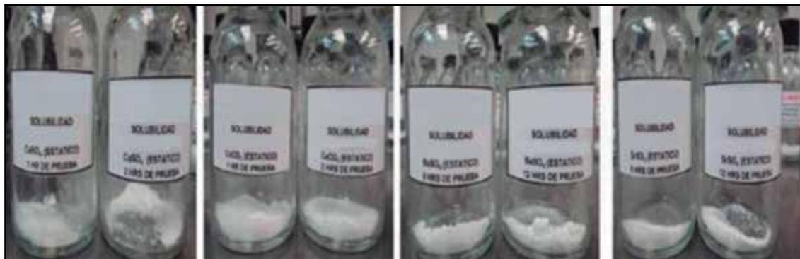
Figura 4. Preparación de la muestras para prueba de solubilidad con  $\text{CaCO}_3$ ,  $\text{CaSO}_4$ ,  $\text{BaSO}_4$  y  $\text{SrSO}_4$ .
