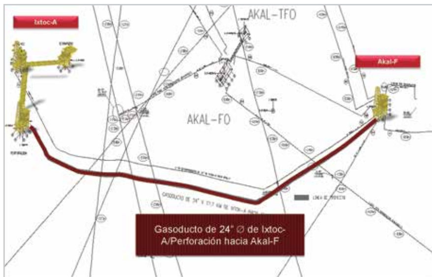
Figura 9. Gasoducto de 24" de Ixtoc-A hacia Akal-F.
