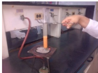
Sólido (12,901 g) + 64,50 mL de NaOH al 3 % m/v (1:5)+ calentamiento (10 min) + enfriamiento a temperatura ambiente ( \pm 25 °C) + decantación para la separación de la fase sólida.
