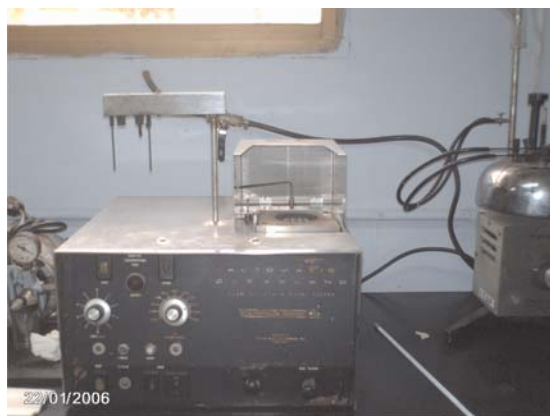
Figura 5. Montaje copa abierta de Cleveland.
