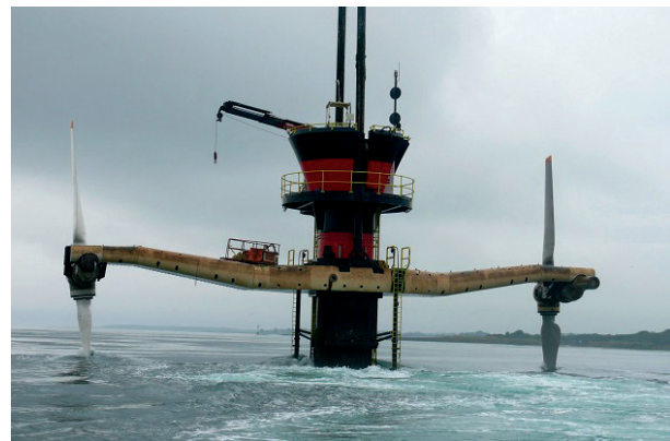
Figura 2. Sistema SeaGen desarrollado por MCT (Marine Current Turbines Ltd., Reino Unido) para producción de energía mareomotriz. Fuente: http://renews.biz/wp-content/assets/MCT-SeaGen-credit-Seb-Kennedy-reNews1.jpg
