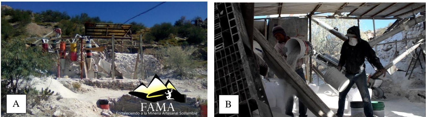
Figura 4. Las fotografías muestran la zona de extracción artesanal de calcita, A) Visualización de maquinaria improvisada como armazones (uso de contenedores metálicos de 200 L como tolvas), fotografía tomada por: Ing. Francisca Monge Amaya, integrante de FAMA; y B) Mineros Artesanales de la Cantera “Las Minitas”. En la fotografía se puede apreciar la falta de equipo de seguridad y materiales de trabajo
