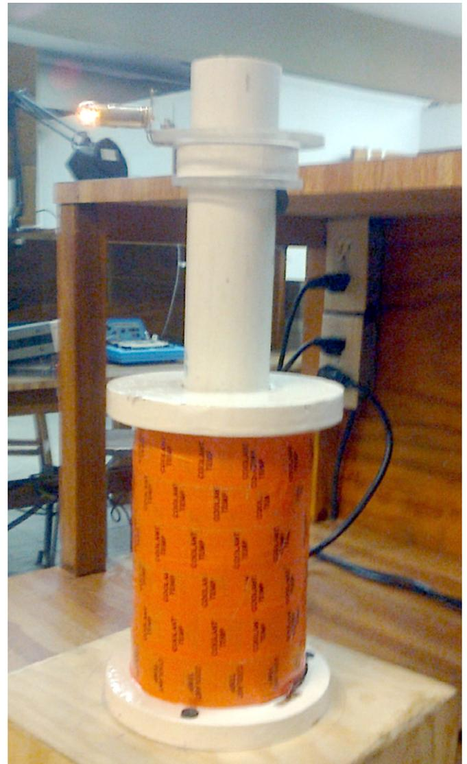
Figura 5. Efecto transformador de voltaje con lamparita.
