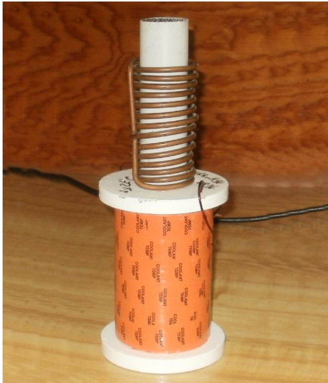
Figura 6. Transformador de corriente.
