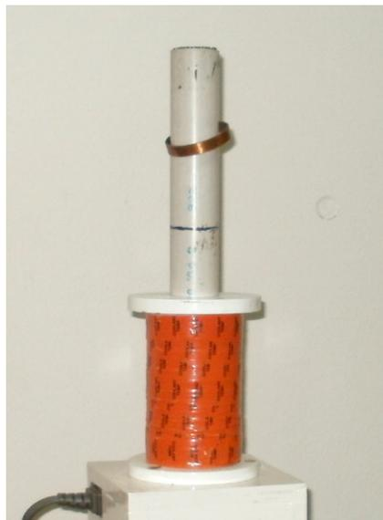
Figura 2. Aro levitador en la Bobina de Thomson.
