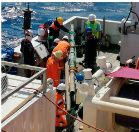
**Figura 13 . Estudios de sedimentos a bordo del ARC "Roncador" por medio del Pistón Corer.**
