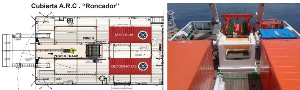
Figura 2. Distribución de los equipos de Pistón Corer y Heat Flow en la cubierta de trabajo del buque ARC “Roncador”.
