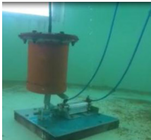
Figura 18. Colocación boya SEPIRB y sistema de liberación en el agua Fuente: Autores
