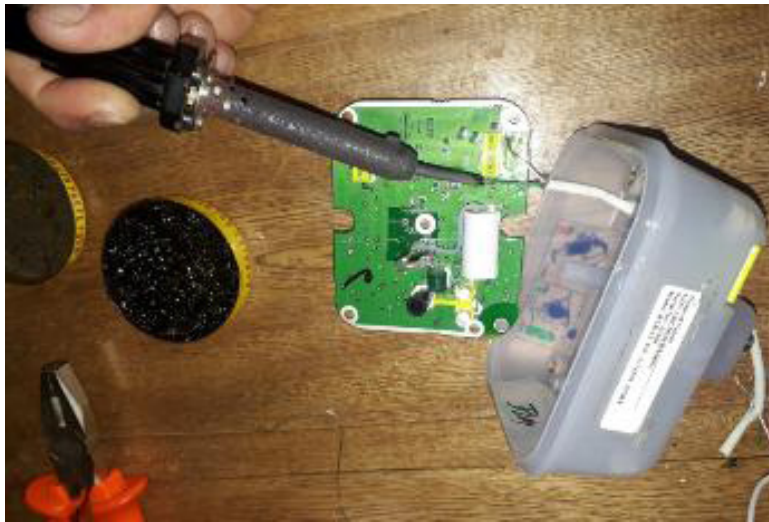
Figura 1. Modificación circuito electrónico – Reed switch - Fuente: Autores
