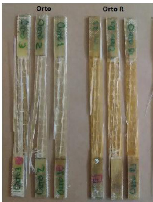
Figura 4. Estado final de las probetas luego del ensayo de tracción.
