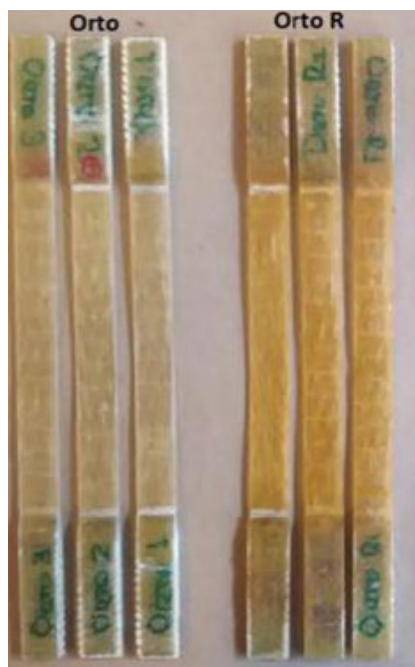
Figura 3 Probetas con y sin radiación UV
