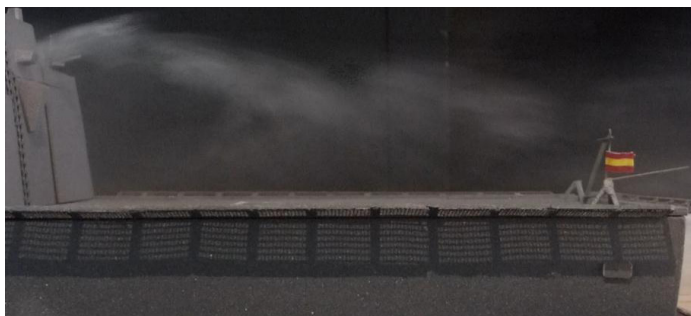
Figura 7. Visualización del flujo mediante humo (Fuente: UPM)
