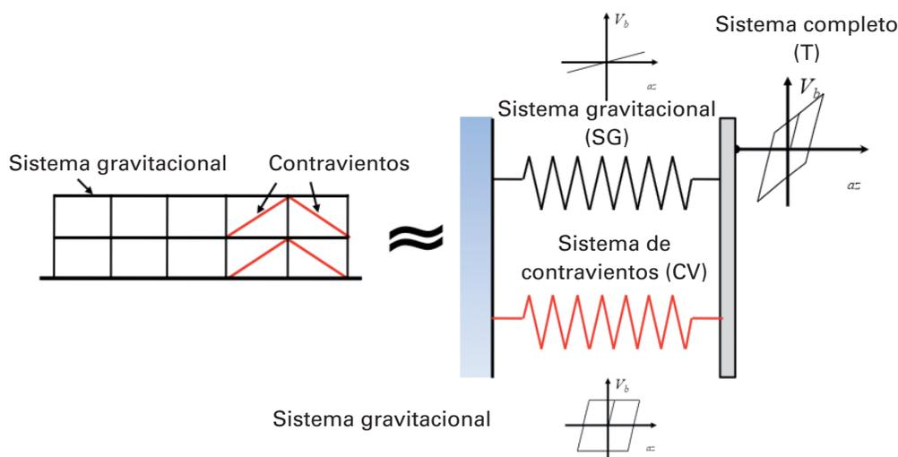
**Fig. 4.** Comportamiento propuesto para una estructura tolerante a daño.
