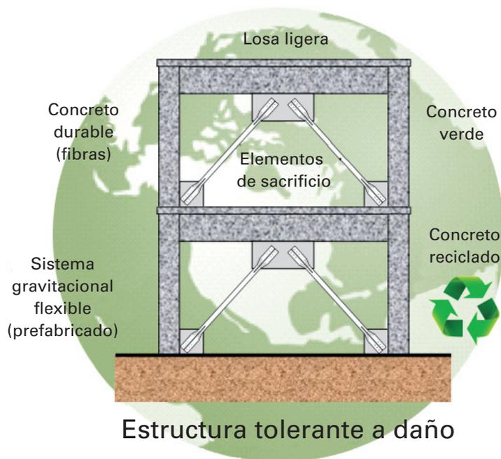
**Fig. 5** Sistema estructural sismorresistente de concreto reforzado para una edificación verde.
