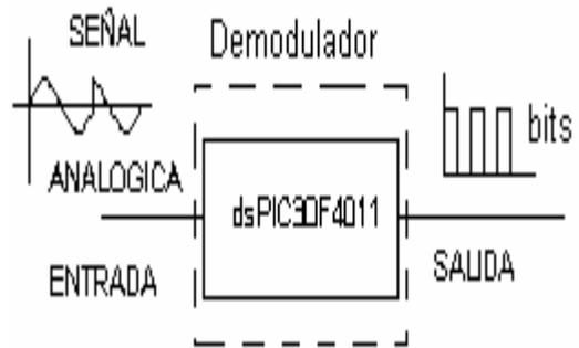
Fig. 4 Diagrama a bloques del demodulador.
