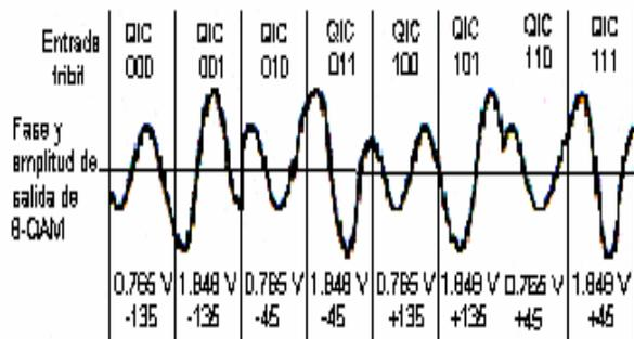
Fig. 2 Forma de onda del modulador tipo QAM.
