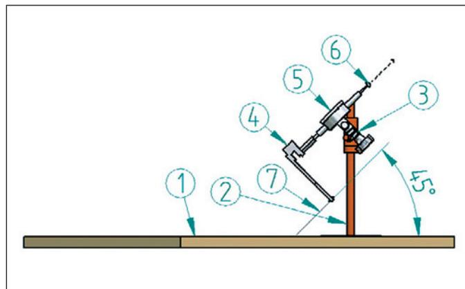
Figura 1 - Desenho esquemático do aparelho de medidas mostrando: Base de madeira (1); Haste vertical (2); Junta giratória (3); Célula de carga (4); Relógio comparador (5); Manipulo (6); Fio (Paralene 6,0) que conecta o globo ocular ao aparelho (7)
