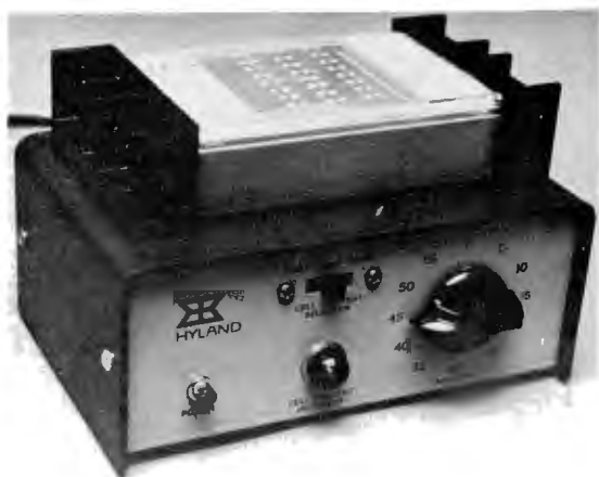
FIG. 2. Fotografía del equipo sencillo sometido a prueba, que consiste en una unidad compacta para electroforesis.
