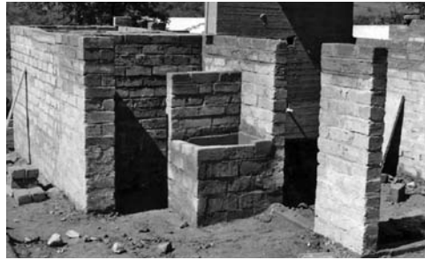
Figura 10: Ensayos de muros de adobes.
