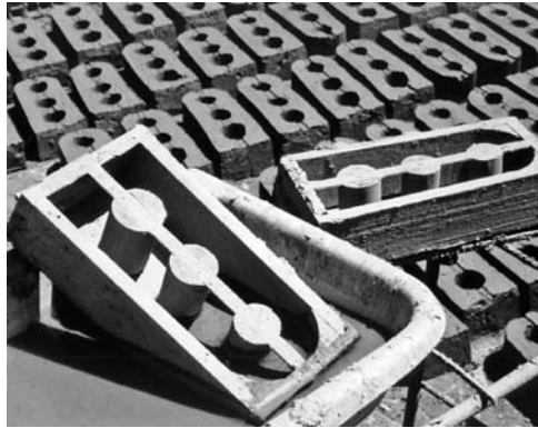
Figura 12: Adobes acústicos hechos a mano con moldes de madera.
