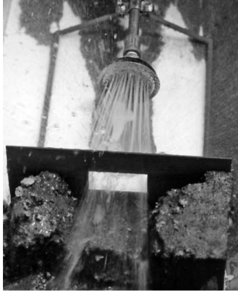
Figura 1: Prueba de erosión realizada sobre un bloque de tierra comprimida no estabilizado.
