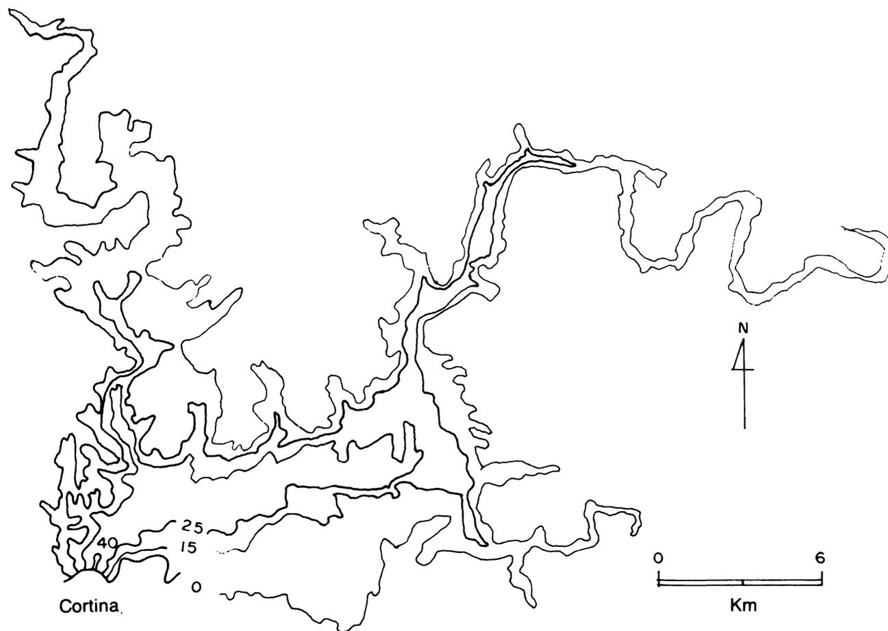
FIG. 3. Mapa batimétrico del vaso de la presa Sanalona. (Isobatas en m.)
