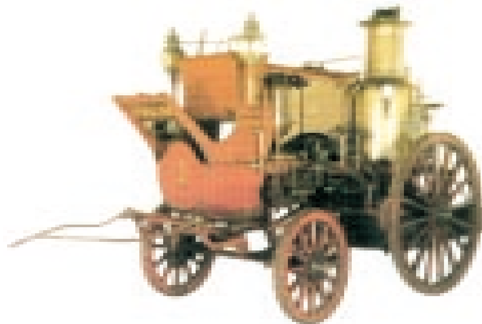
FIGURA 2 – Carro de bombeiros do final do século XIX, integrante da primeira frota do Corpo de Bombeiros de São Paulo. Trata-se de um carro-bomba, destinado a bombear água de rios e tanques e canalizá-la para incêndios por meio de mangueira. A pressão da água era provocada por vapor produzido pela caldeira, alimentada por carvão e lenha. Fabricado em Londres, Inglaterra, pela Merryweather & Sons Fire Engine Makers, no modelo Greenwich, tinha capacidade para processar 1620 litros de água por minuto e produzir jatos de até 49 metros de altura. Recebeu, em São Paulo, o nome de Siqueira Campos, em homenagem ao chefe de polícia que muito havia contribuído para o desenvolvimento do Corpo de Bombeiros. Foi trazido para o Museu Paulista na década de 1950, por membros daquela corporação preocupados em preservar os últimos exemplares dos antigos carros. Acervo Museu Paulista da USP.
