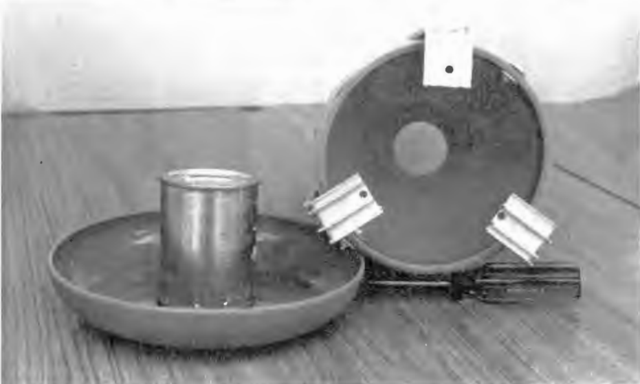
Figuras 1 y 2 Trampa NTP-80. 1) Elementos que constituyen el dispositivo de plástico y aluminio. 2) Último paso del ensamblado de la trampa.
