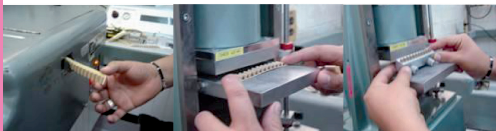
Figura 4. Equipo utilizado para evaluar las resistencias en el corrugado.
